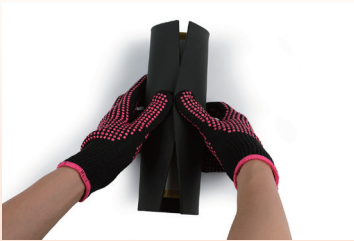
Enveloppez le gobelet avec le tapis de presse à chaud
